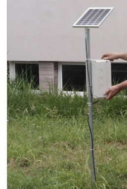
Фиг. 3. Прототип на IoT модул за мониторинг състоянието на почвата
