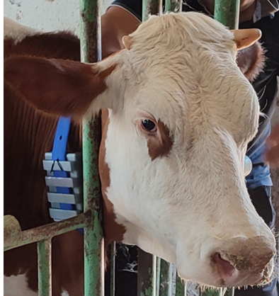
Фиг. 2. Прототип на IoT модулите за мониторинг поведението на крави
