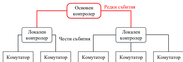
Фиг. 6. Двуслойна йерархична архитектура на контролна равнина
