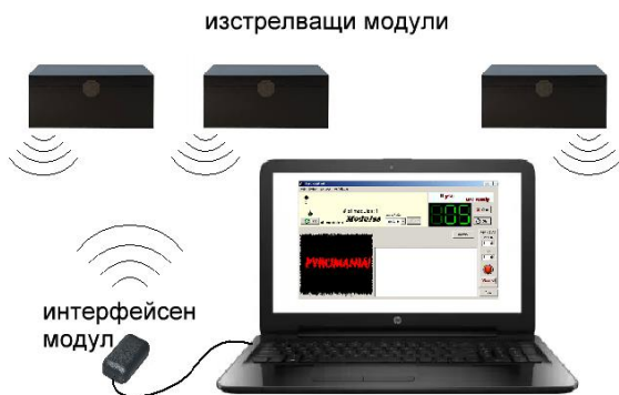
Фиг.1. Система за управление на фойерверки: компютър, интерфейсен модул, изстрелващи модули.
