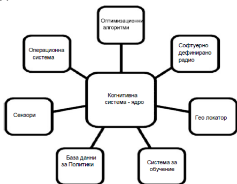
Фиг. 3. Компонентите на когнитивните терминали за 5G
