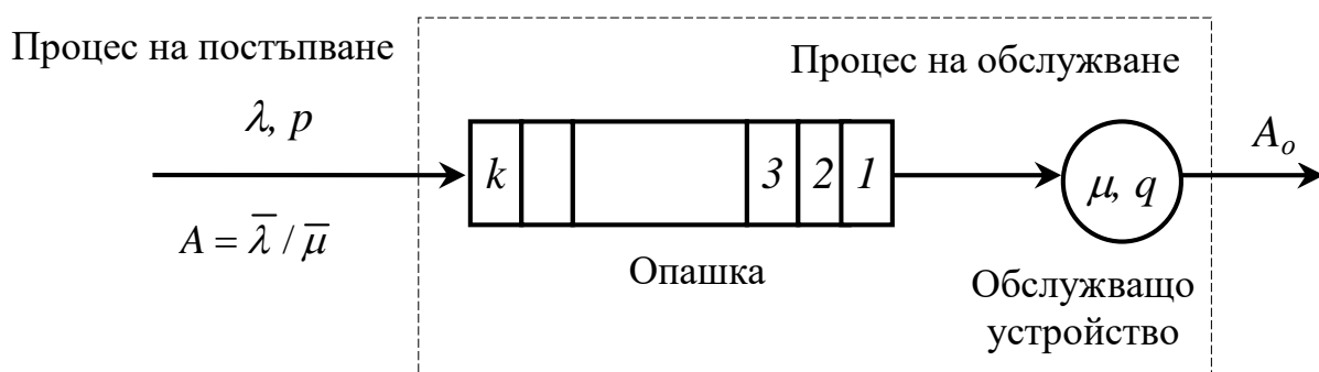
Фиг.1. Обобщена едноканалната система с чакане – M(g)/M(g)/1/k .
