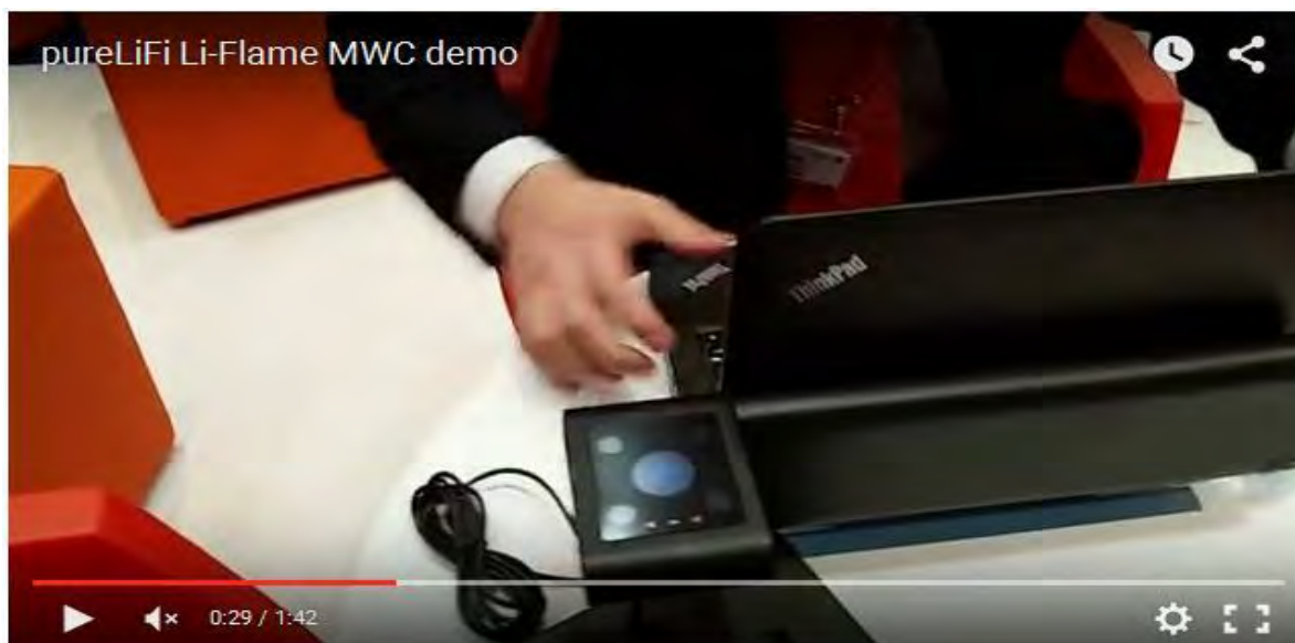
Фиг.3 Приемо-предавател за връзка с клиентско устройство ( смартфон. лаптоп или таблет) чрез USB порт.
