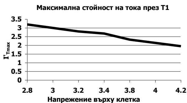
Фиг.12. Максимална стойност на тока през T_1 , при РИОДОНКК
