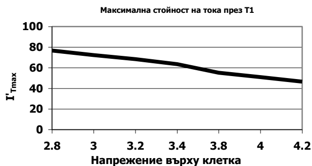
Фиг.13. Максимална стойност на тока през T_1 , при РИОД
