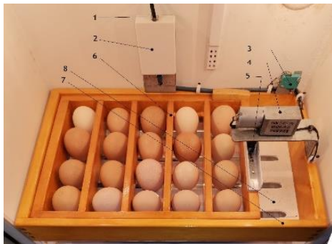
Фиг. 3. Обръщащ механизъм за въртене на яйцата в инкубатора
